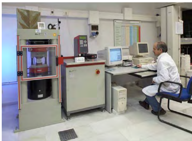
Συσκευή προσδιορισμού αντοχής σε θλίψη.
