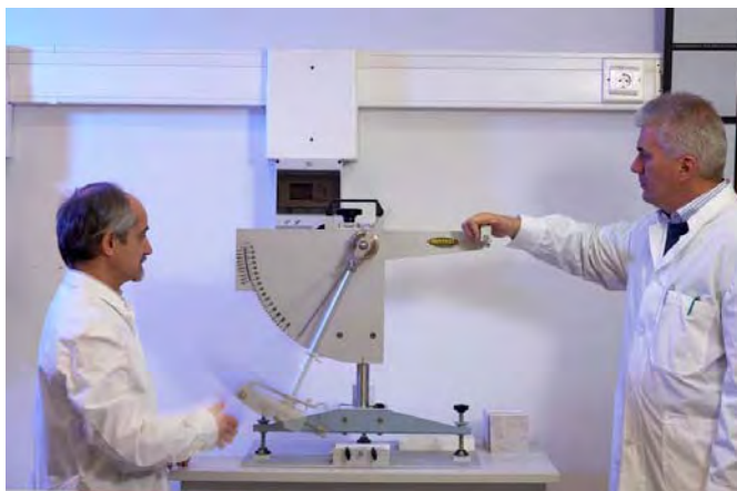
Συσκευή προσδιορισμού αντίστασης σε ολισθηρότητα.
